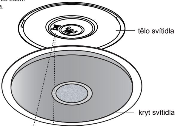
① signál-přenášející součást, přijímající signály dálkového ovladače.
