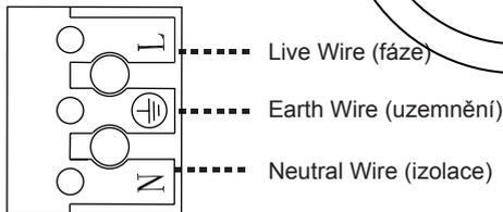
Lead-in Wire (přívodní kabel) → 11~12mm
