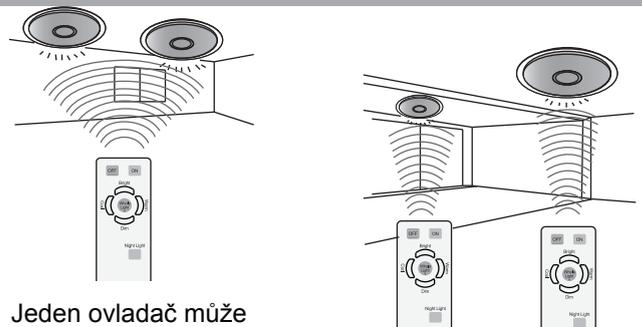
Jeden ovladač může současně ovládat dvě svítidla, pokud jsou obě svítidla nastavena na CH1.
